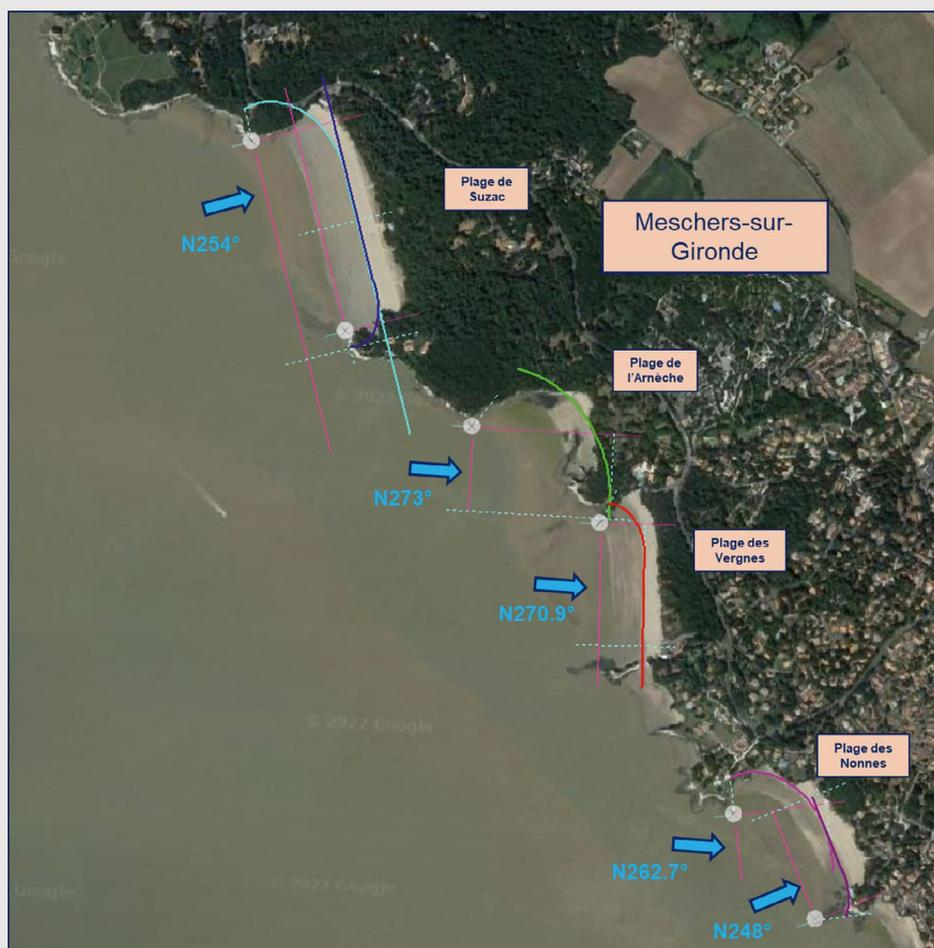
**Figure 36** – Exemple d'application du modèle parabolique de Hsu et Evans sur les côtes de la commune de Meschers-sur-Gironde (Artelia, 2022)
