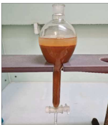
Figure 18. Récupération des billes de mercure par décantation
