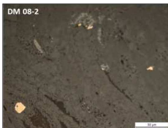
Figure 46. Grains d'or associés à des oxydes de fer de remplacement de la pyrite et en inclusion dans la pyrite, échantillon de Dieu Merci. Echelle du microscope : 50 \mu\text{m} .
