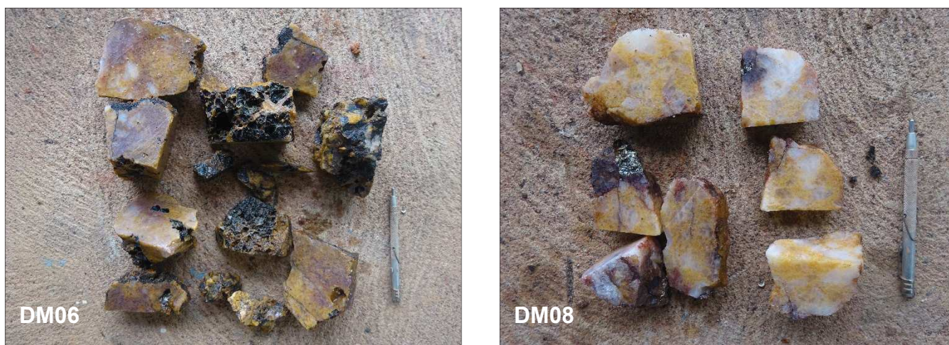
Figure 27. Facies cariés à quartz, oxyde de fer et pyrite résiduel (échantillon DM06 et DM08). On y observe de nombreuses cavités issues de l'altération de sulfures préexistants, probablement particulièrement abondants initialement dans ce type de facies
