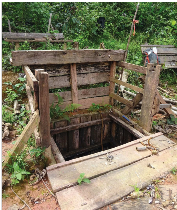
Figure 36. Puit d'orpaillage illégal sur le site de Grand Usine, permettant l'exploitation en souterrain des veines et des filons de quartz aurifère
