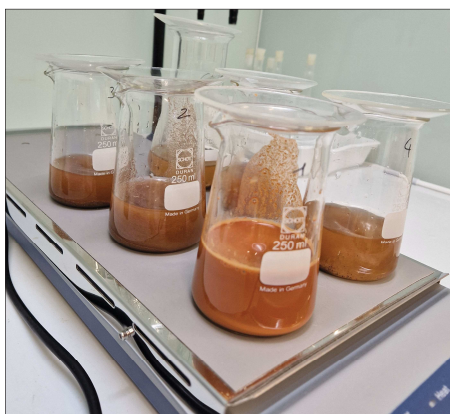
Figure 17. Mise en pulpe avec Hg et agitation
