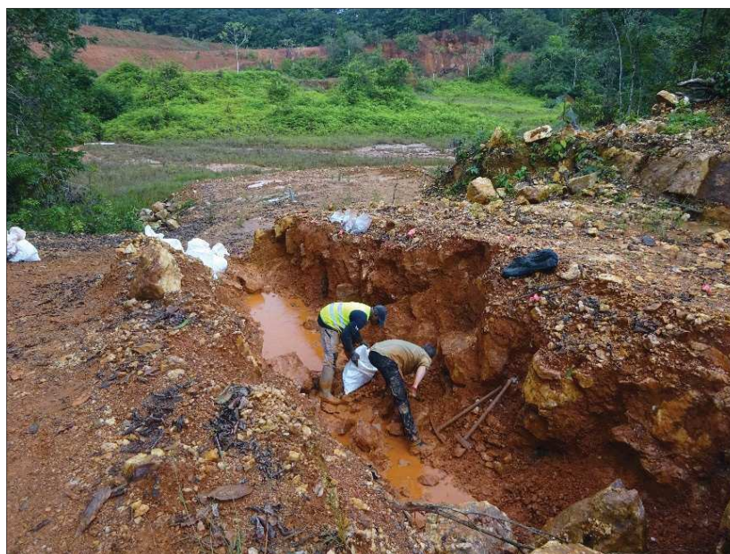
Figure 28. Prélèvement de l'échantillon DM01 sur le site de Dieu Merci. L'échantillonnage a consisté à effectuer un prélèvement composite sur la largeur de la zone filonienne
