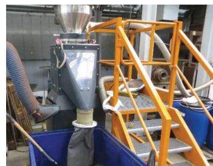
Concasseur à cône SIEBTECHNIK KM65
