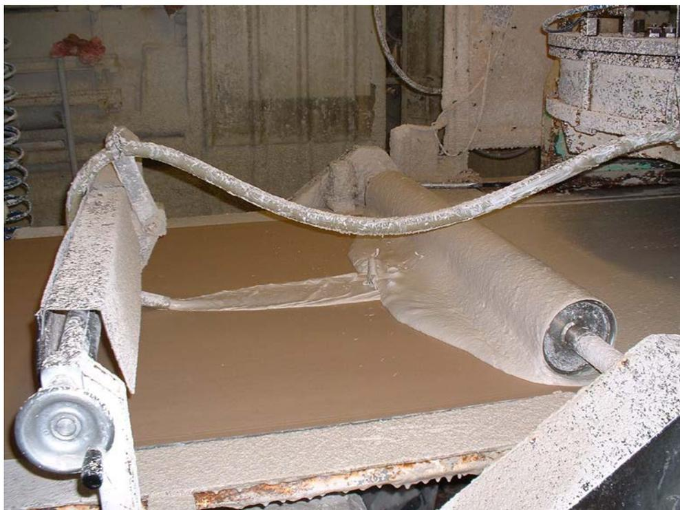
*Figure 38 : Fabrication de plaques de plâtre dans l'usine de Carpentras (ancien site Lafarge, propriété du groupe Siniat). Cliché : BRGM, 2003.*
