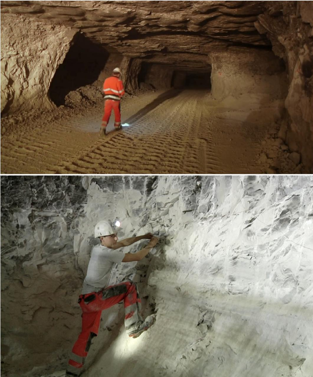
Figure 34 : Carrière souterraine de Kœnigsmacker (57). Front d'exploitation d'anhydrite dans le Trias supérieur (Keuper) et vue sur les chambres et piliers. Clichés : <https://viamirabelle.tv>.
