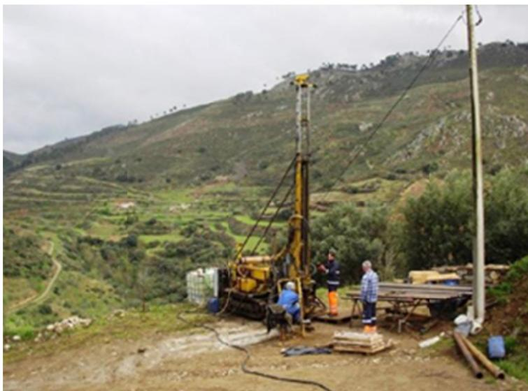
Figure 16 : Sondage d'exploration du gisement de Tabuaço (Source : ColtResources.com).
