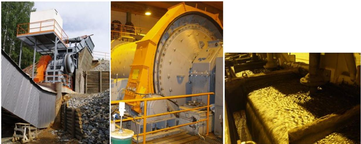
Figure 10 : Les différentes étapes du traitement des minerais dans l'usine de Luikonlahti. Gauche : le broyage ; Centre : le concassage ; Droite : la flottation (Source : Altona Mining Ltd).
