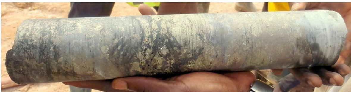
Figure 7 : Carotte à minerai aurifère issue d'un sondage carotté, en Côte d'Ivoire (Cliché : P. Urien, BRGM).
