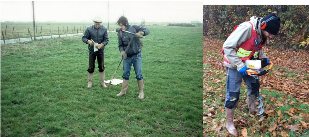
Figure 1 : Prospection géochimique à la tarière à main en Vendée (Cliché à gauche : BRGM) ou à la moto-tarière sur le permis de Saint-Pierre-Montlimart, en France (Cliché à droite : Variscan Mines).
