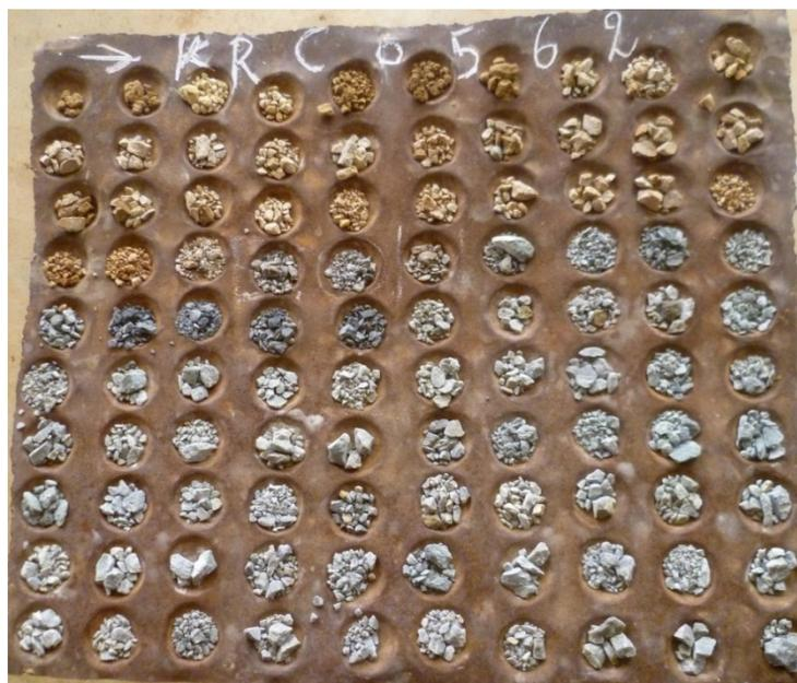
Figure 9 : Eclats ("cuttings") de roche issus d'un sondage destructif, en Côte d'Ivoire (Cliché : P. Urien, BRGM).
