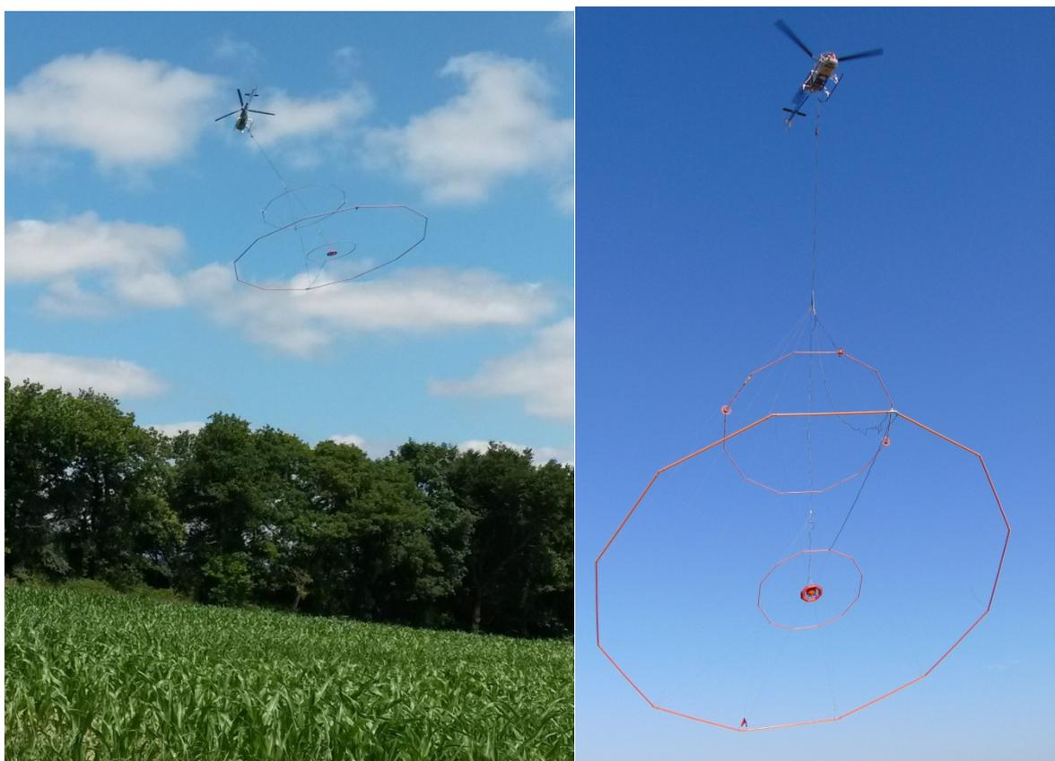
Figure 4 : Levé géophysique aéroporté avec le système VTEM<sup>TM</sup> plus (Versatile Time-Domain Electromagnetic geophysical system) de Geotech Airborne Ltd, avec un hélicoptère de Airwalser. PER Merléac, en Bretagne (Cliché : Variscan Mines).
