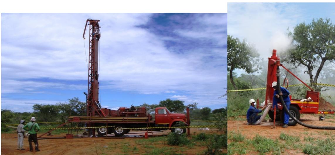
Figure 8 : Exemple de sondeuse utilisée pour les sondages destructifs et équipement de récupération des échantillons (à droite) (Cliché : L. Bailly, BRGM).
