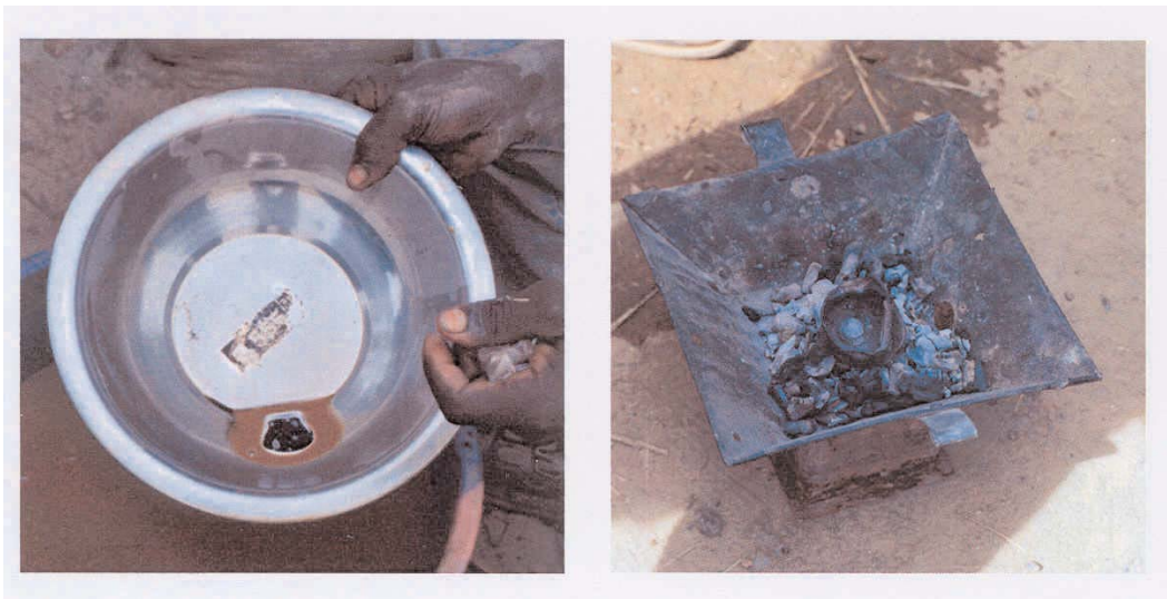
Photos 2 et 3 - Amalgamation de l'or au mercure en fin de traitement gravimétrique puis grillage en circuit ouvert de l'amalgame (Photos E. Jaques)
