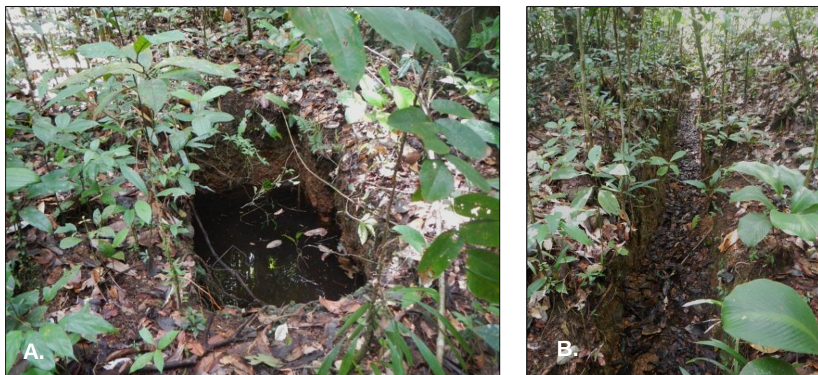
Figure 20 : Travaux de prospection historiques du BMG observés lors de la mission d'échantillonnage en 2013. Puits de prospection (A) et tranchée (B) réalisés pour le cubage des alluvions-éluvions de l'indice Balata-Jupiter (Billa et al., 2014).
